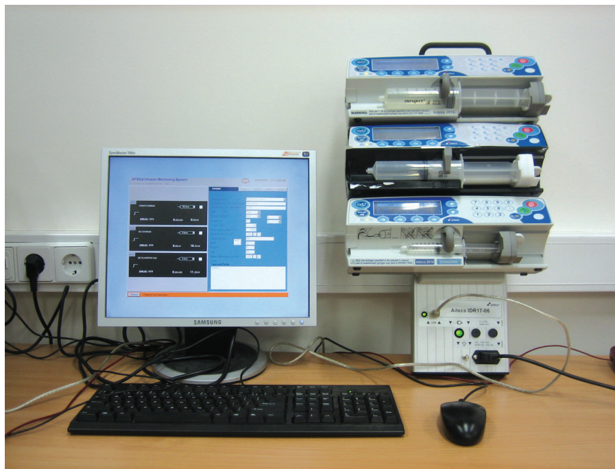
Švirkštinių infuzijos siurblų sujungimo sistemos kompiuterizuota valdymo sistema (prototipas), vadovas doc. V. Markevičius.
